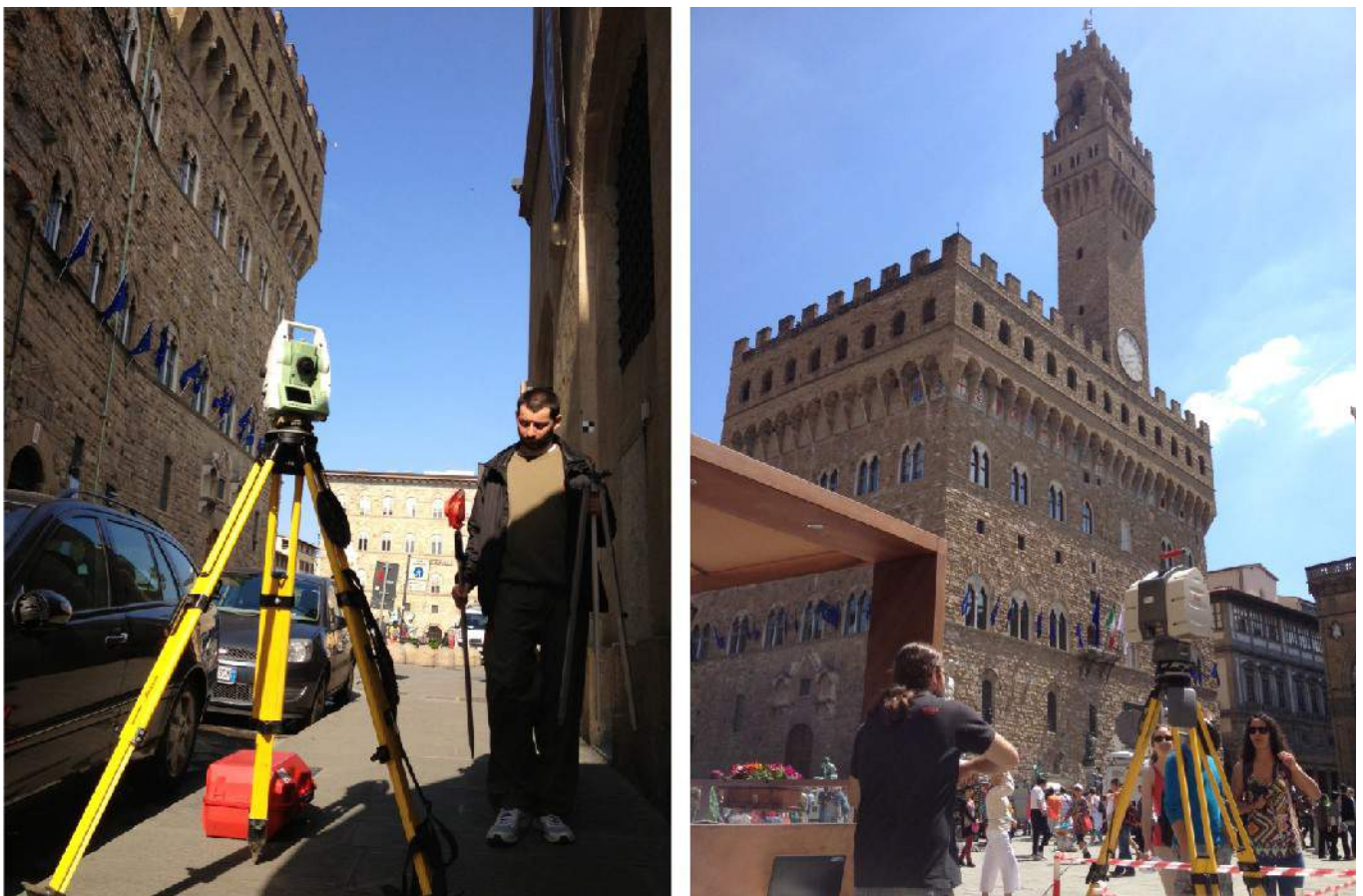
Fig. 1: le operazioni di rilevamento del monumento, sulla sinistra la stazione totale e a destra lo scanner laser.
